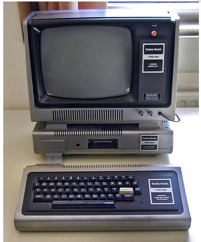
Fig.4 - Un TRS-80 Level I (notare la tastiera senza tastierino numerico) con Expansion Interface (il case addizionale posto sotto al monitor) (foto di Flominator, fonte Wikimedia Commons)
